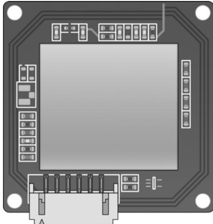
La figure suivante montre les connexions de l'interface pour l'hôte UART.
