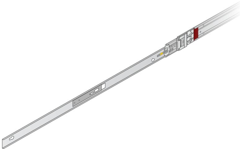
3. Richten Sie die Schlüsselsteckplätze an den T-Bolzen an den Seiten des Servers aus und schieben Sie dann die Montagehalterung zurück, bis sie einrastet.
