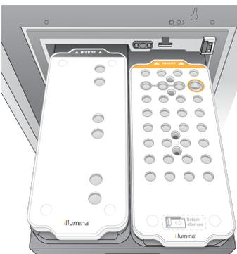
5. Schieben Sie die Schublade in den Kühler und schließen Sie die Reagenzienkühlertür.
