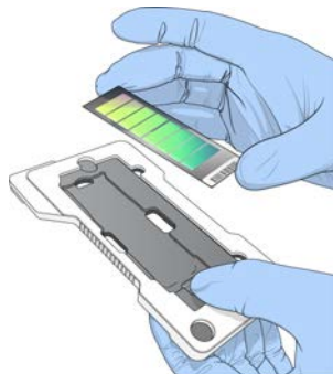
Obrázek 19 Vložení BeadChipu do adaptéru
