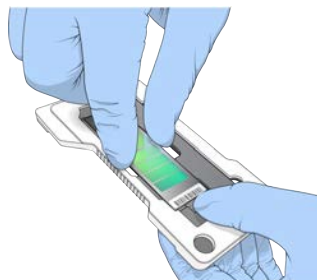
Obrázek 20 Usazení a zabezpečení BeadChipu
